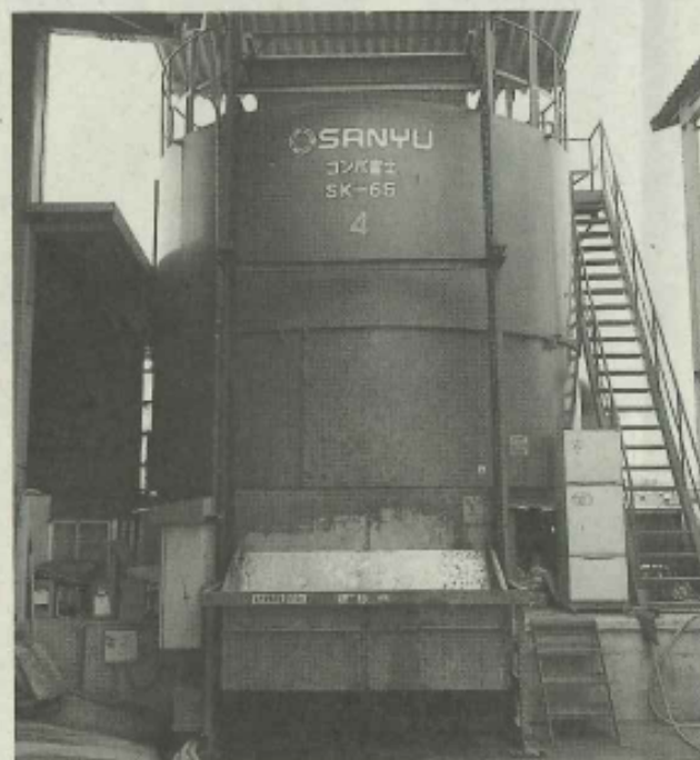
家畜の糞尿を発酵させ、良質な有機堆肥にする縦型 コンポスト(たい肥化装置)
